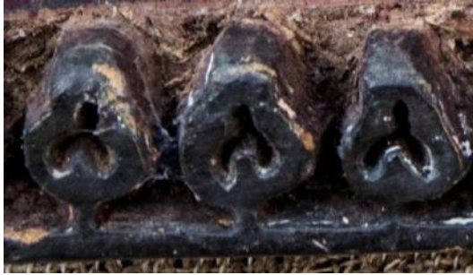
Resim 34a. Erkut ailesinin yazma yapımında kullandığı baskı kalıbı: Kenar Deseni 4 Detay ve teknik çizim
