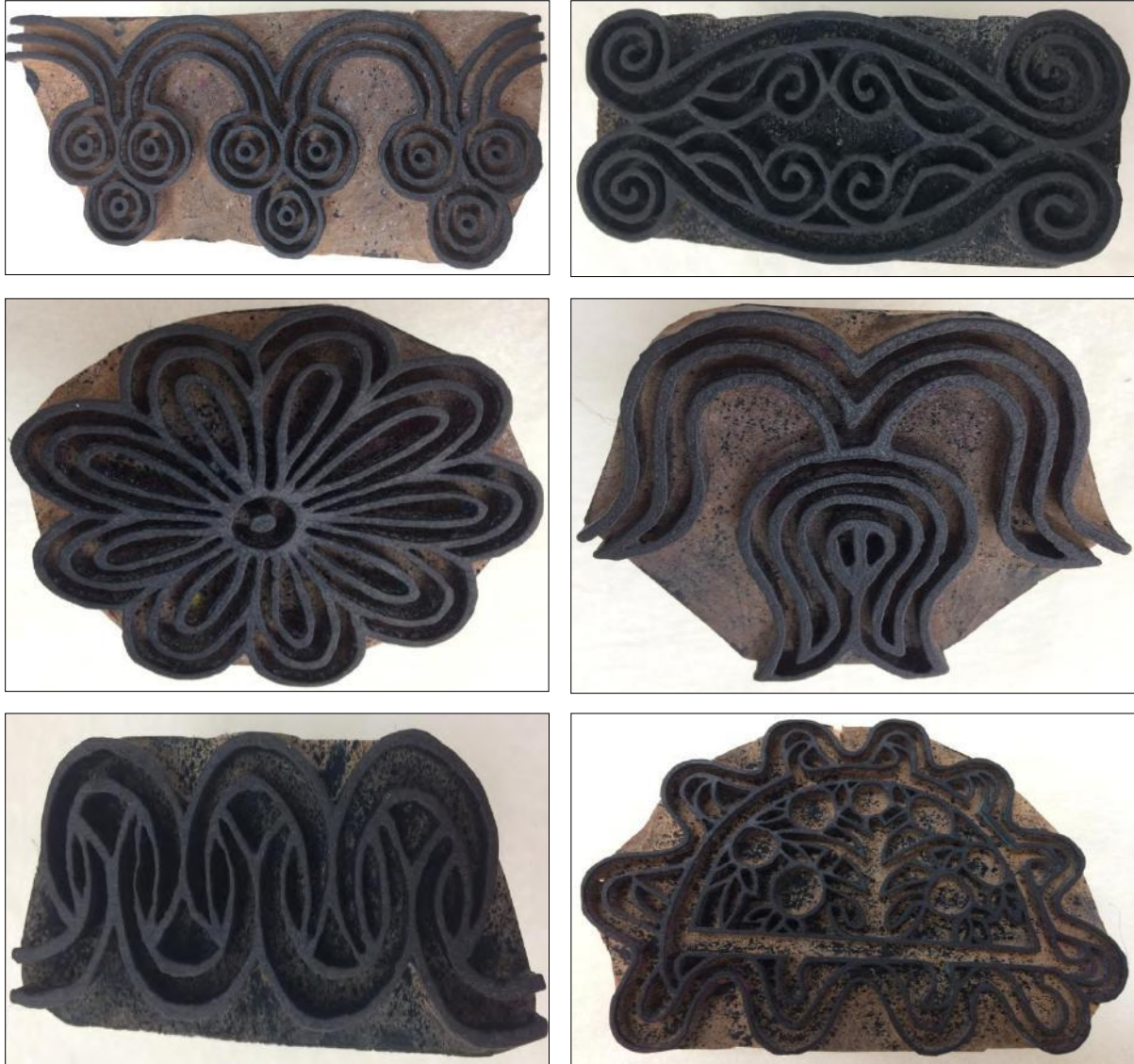
Resim 25.26.27. 28.29. 30. Masa Örtüsü Baskısında Kullanılan Altı Ahşap Kalıp (Mart 2020, N. Aydın fotoğraf albümü)
