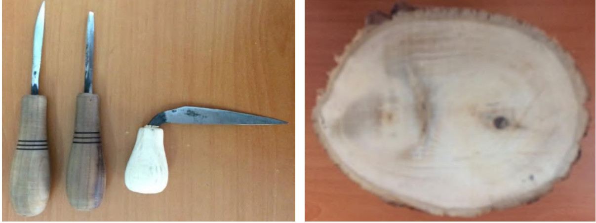
Resim11. Ahşap Kalıp Oyma İşleminde Kullanılan Aletler ve Ihlamur Blok( N. Aydın foto albümü, Mart 2020)
