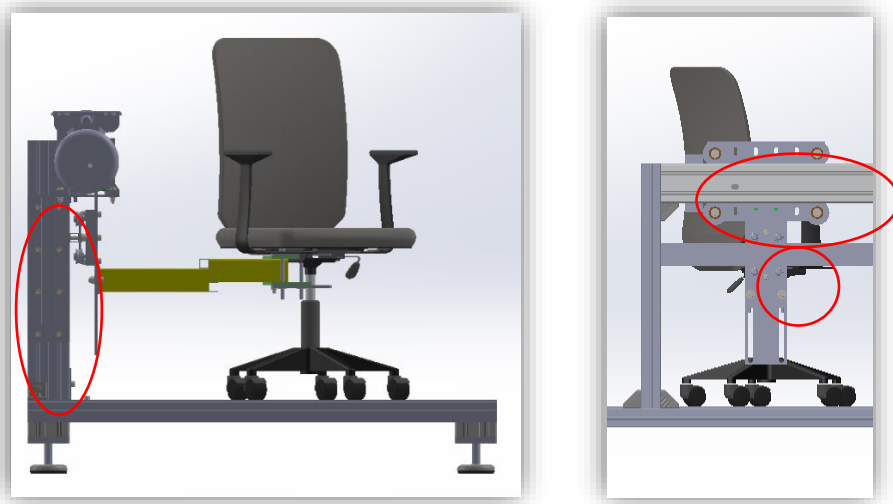
Şekil 9. TS EN 1335-3 standardınca tasarlanmış deney düzeneğinin 3 boyutlu tasarım görseli
