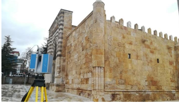
Şekil 2. Kırşehir İli Cacabey Medresesi 3D Lazer Tarama Uygulaması
