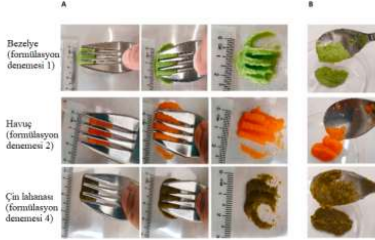
Şekil 3. A: 3D baskılı örnekler üzerinde çatal basınç testi, B: Optimize gıda mürekkepleri üzerinde kaşık eğme testi (Pant ve ark., 2021)
